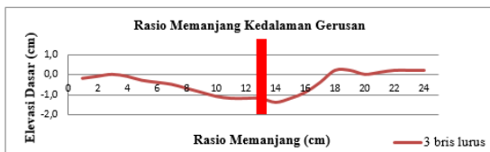
Gambar 25. Hubungan Kedalaman Gerusan Dengan Kecepatan Geser Pada Model Pilar dengan Tirai 3 Baris Lurus
