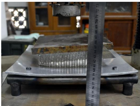
Gambar 10. Hasil pengujian spesimen impact attenuator tipe 2.
