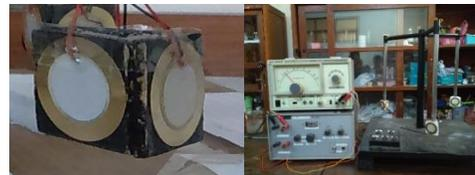
**Gambar 1.** Alat Sonikasi. Probe Sonikasi(kiri). Set alat Sonikasi(kanan)
