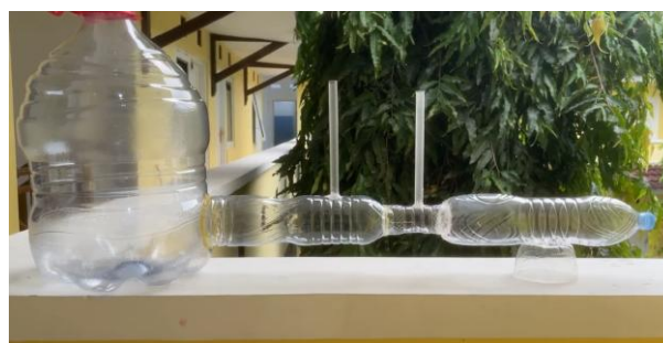
Gambar 2. Rangkaian percobaan tabung venturimeter
