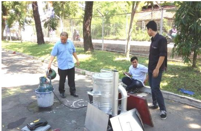
Gambar 3. Uji coba tungku pelebur.
