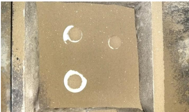
Gambar 11. Pembuatan cetakan pasir oleh siswa
