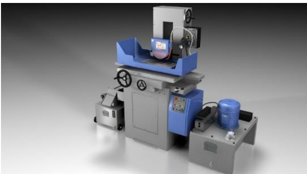
Gambar 2. Desain mesin gerinda datar
