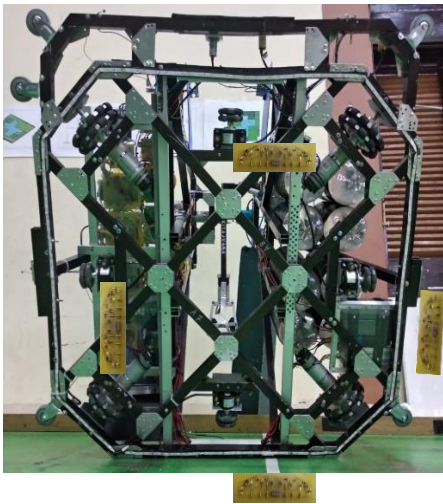
Gambar 14. Pemasangan roda dan sensor garis disesuaikan dengan program.
