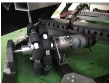
Gambar 9. Pemasangan roda omni
