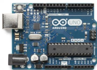
Gambar 3. Modul input-output Arduino UNO
