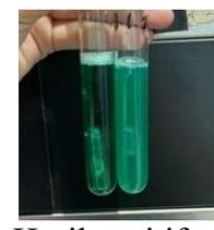
Gambar 4. Hasil positif uji penegasan *Coliform* pada media BGLBB
