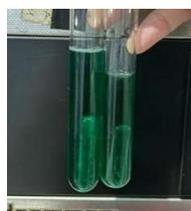
Gambar 3. Hasil negatif uji penegasan *Coliform* pada media BGLBB
