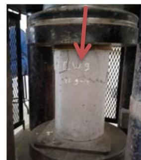
Gambar 1. Metode Pengujian kuat tekan beton
