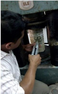
Gambar 2. Metode Pengujian Angka Pantul Beton
