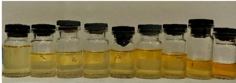
**Gambar 5.** Perubahan warna limbah MO dengan semakin lama proses fotokatalisis (dari kanan ke kiri).
