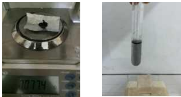
Gambar 3. Hasil serbuk graphite oxide a) dan sampel larutan graphene oxide setelah proses ultrasonikasi b).
