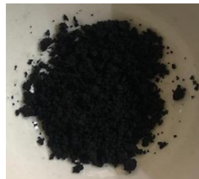
Gambar 2. Serbuk anoda baterai ZnC sebelum kalsinasi.
