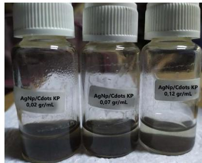
**Gambar 4.** Larutan AgNp/C-dots KP dengan variasi konsentrasi C-dots KP.
