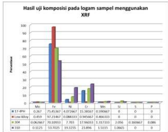
Gambar 2. Grafik hasil uji komposisi logam baja menggunakan XRF
