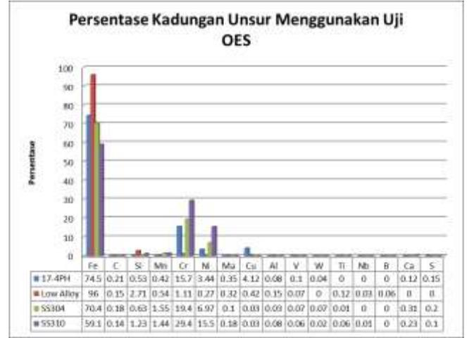
Gambar 3. Grafik hasil pengujian kandungan unsur logam menggunakan OES
