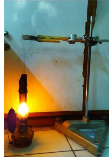
**Gambar 1.** Pengasapan karbon dengan lampu teplok
