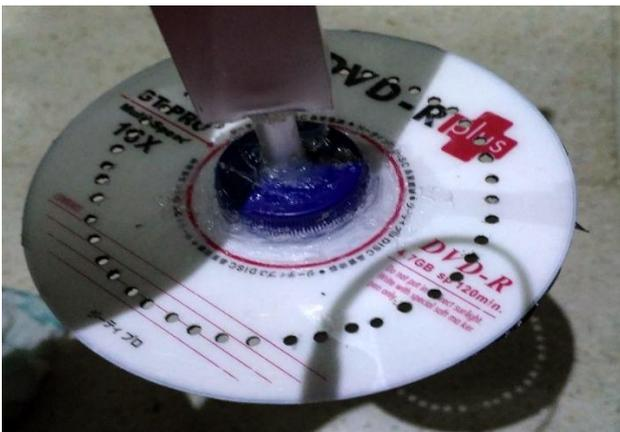
Gambar 19. Desain fisik cakram berlubang dengan diameter 12 cm
