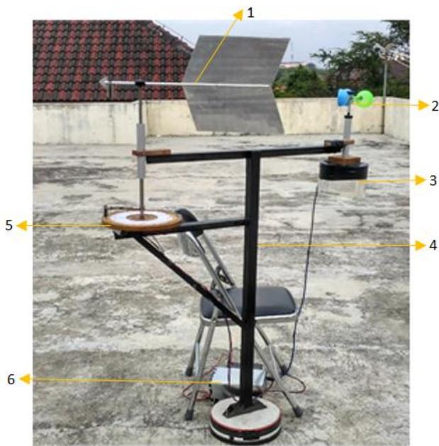
Gambar 37. Hasil perancangan anemometer dan *wind vane*
