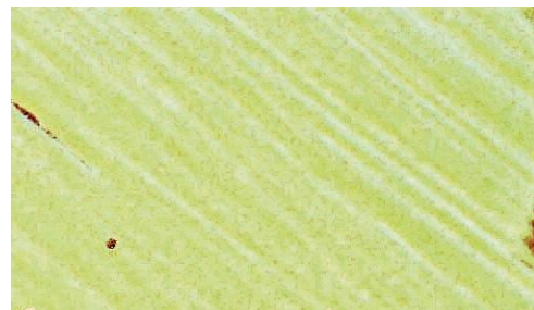
Gambar 7 a). Foto Mikroskopi dengan Perbesaran 1000 kali pada Permukaan Baja Karbon API 5L X65 Sebelum Pemaparan.
