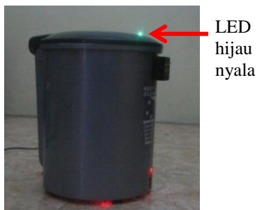
Gambar 3. Kondisi belum penuh
