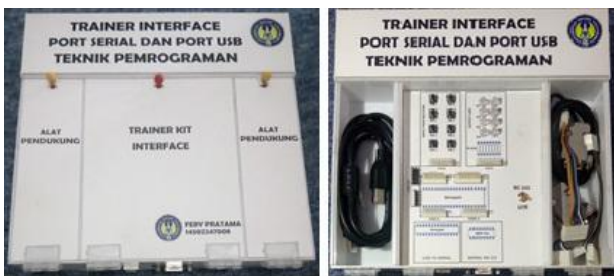
Gambar 3. Pengembangan perangkat keras trainer interface
