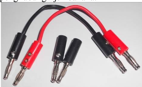
Gambar 9. Pemasangan Jek Banana
