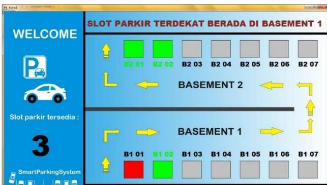
Gambar 13. Tampilan *software* saat slot B101 ditempati mobil
