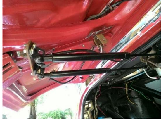
Gambar 3. Pemasangan Hidrolik pada Bagasi
