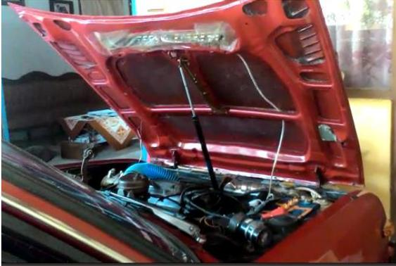
Gambar 2. Pemasangan Hidrolik pada Kap
