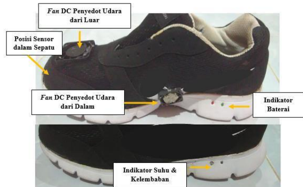
Gambar 6. Prototipe Alat Pengendali Suhu Untuk Mengurangi Kelembaban Pada Bagian Dalam Sepatu Berbasis Arduino Nano.
