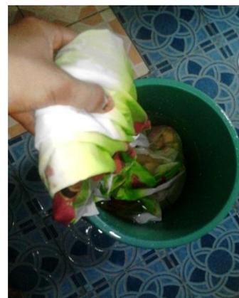
Gambar 5:Penguncian warna dengan *watter glass*
