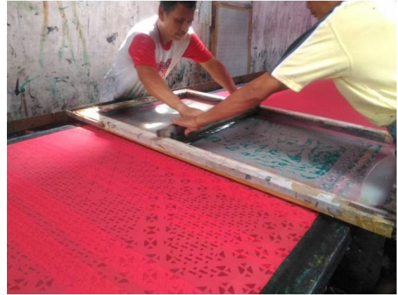
Gambar 6. Proses penyaputan larutan menggunakan rakel (Sumber: Dokumentasi Budiarti, 22 Februari 2018)
