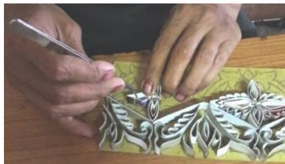
Gambar 15: Proses pembuatan canting cap berbahan limbah kertas kemasan menggunakan teknik sederhana sehingga mudah dan cepat dibuat.
