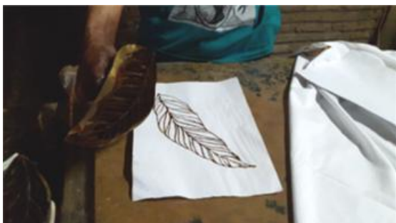
Gambar 13: Percobaan mengecap di atas permukaan kertas untuk memastikan permukaan canting cap bagus atau tidak mblobor atau melebar.
