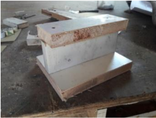
Gambar 8: Dasaran dengan pegangan canting cap siap digunakan.
