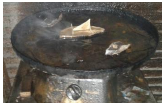
Gambar 10: Canting cap dipanaskan dalam loyang berisi malam panas.
