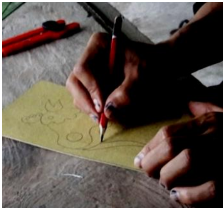
Gambar 1: Menggambar motif yang akan dibuat canting cap di atas kertas karton.
