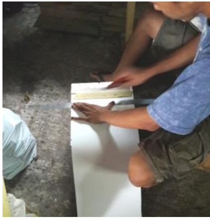
Gambar 16: Membuat bilah-bilah kertas tidak dapat stabil ukurannya, karena masih manual.
