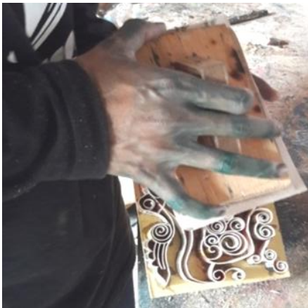
Gambar 9: Mengamplas permukaan canting cap kertas supaya permukaannya rata.
